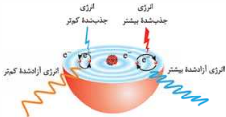
در نتیجه جابه‌جایی الکترون بین لایه‌ها، انرژی با طول موج معین، جذب یا نشر می‌شود.
