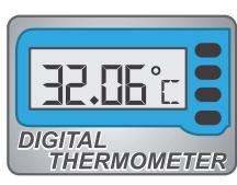
**نمونه** در دماسنجدیجیتال شکل مقابل، که عدد  $32.06^{\circ}\text{C}$  را می‌خواند، دقت دماسنجدیجیتال برابر  $0.1^{\circ}\text{C}$  است.  $32.06^{\circ}\text{C} \rightarrow d = 0.1^{\circ}\text{C}$  و  $\Delta = \pm d = \pm 0.1^{\circ}\text{C}$  آن برابر  $0.1^{\circ}\text{C}$  است.
