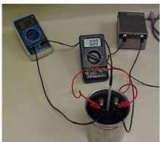
قانون ژول بیان می‌دارد که گرمای تولید شده توسط جریان I عبوری از یک مقاومت R در مدت زمان t برابر  $RI^2t$  است. این قانون را می‌توان به روش گرماسنجی با یک گرماسنج تحقیق کرد که اسباب آن در شکل
