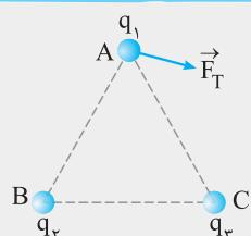
سه ذره باردار در سه مثلث متساوی‌الاضلاعی قرار گرفته‌اند. اگر برایند نیروهای الکتریکی وارد بر بار  $q_1$  مطابق شکل باشد، علامت و اندازه بارهای  $q_2$  و  $q_3$  را با هم مقایسه کنید.
