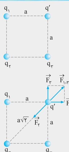
مطابق شکل چهار ذره باردار در چهار رأس مربعی ثابت شده‌اند.  $q_1 = q_4 = +\lambda n C$
