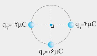
مطابق شکل سه بار الکتریکی روی دایره‌ای با شعاع  $10\text{ cm}$  قرار دارند. بزرگی نیروی وارد بر
