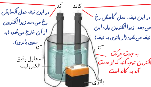
شکل ۱۱- تجزیه آب به گازهای هیدروژن و اکسیژن با مصرف انرژی الکتریکی آند (قطب مثبت) و کاتد (قطب منفی) سلول هستند.
