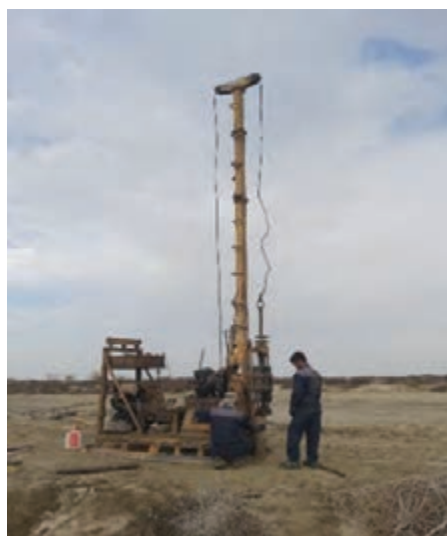
شکل ۳-۶ حفاری گمانه اکتشافی توسط دستگاه حفاری
