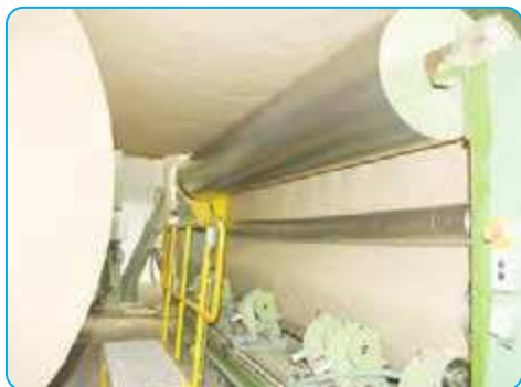
غلتک آهنی برای صاف کردن خمیر کاغذ
