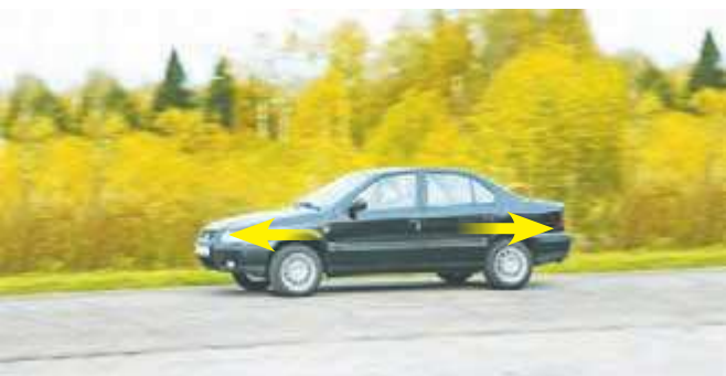
شکل ۳- وقتی نیروهای وارد بر خودروی در حال حرکت متوازن باشند، خودرو با سرعت ثابت حرکت می‌کند.
