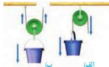
شکل ۱۲ - قرقره ثابت و قرقره متحرک
