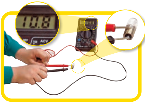
شکل ۸- اندازه‌گیری مقاومت لامپ خاموش با اهم سنج
