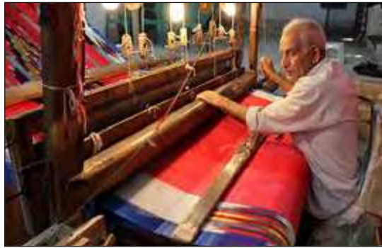
دستگاه ساده بافی (دارایی بافی)
