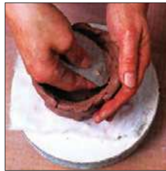
▲ پرداخت کردن سطح داخلی ظرف سفالی.
