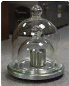
شکل ۱-۷ استاندارد ملی کیلوگرم که نسخه دقیقی از استاندارد بین‌المللی سور فرانسه است. این نمونه، در مرکز اندازه‌شناسی در سازمان ملی استاندارد ایران نگهداری می‌شود.
