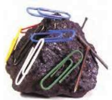
شکل ۱-۳ سنگ آهنربای طبیعی. تالس که اغلب از او به عنوان پدر علم یونان یاد می‌شود، ماده کانی مگنتیت Fe_3O_4 را که ویژگی آهنربایی دارد می‌شناخت.
