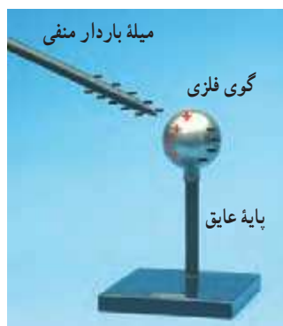
شکل ۲۷-۱ نزدیک کردن میله باردار منفی به گوی فلزی خنثایی که روی پایه عایقی قرار گرفته است، موجب ایجاد بارهای القایی مثبت و منفی در دو طرف گوی فلزی می‌شود.
