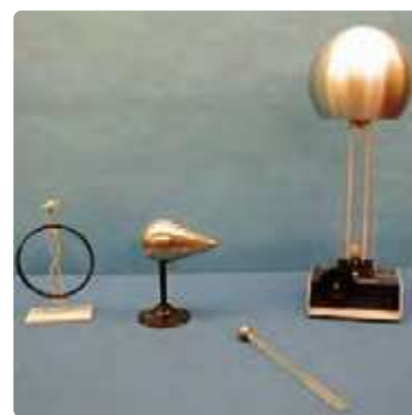
شکل ۲۸-۱ اسباب آزمایش چگونگی توزیع بار روی سطح خارجی یک جسم رسانای باردار
