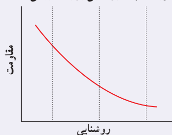
(پ) مقاومت بر حسب روشنایی برای یک LDR نوعی
