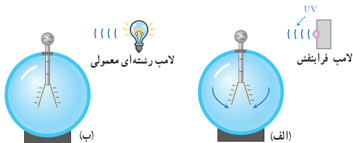
شکل ۱-۵ الف برهم‌کنش نور فرودی فرابنفش با کلاهک برق‌نما سبب می‌شود تا ورقه‌های آن به سرعت به هم نزدیک شوند. (ب) در حالی که برهم‌کنش نور مرئی گسیل‌شده از یک لامپ رشته‌ای تغییری در انحراف ورقه‌های برق‌نما به وجود نمی‌آورد.
