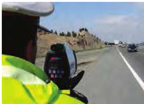
شکل ۳۰-۳۰ تعیین تندی خودروها به کمک اثر دوپلر
