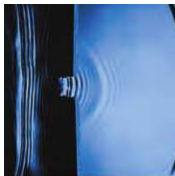
شکل ۴-۲۶ پراش امواج تخت هنگام عبور از شکافی باریک در تشت موج
