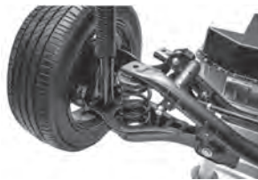
شکل ۲-۱۴ فنرهای به کار رفته در چرخ‌های خودرو
