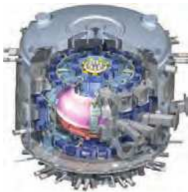
شکل ۱۵-۶ طرحی از راکتور آزمایشی گرما هسته‌ای بین‌المللی (ITER). ساخت این راکتور با مشارکت چندین کشور جهان، از سال ۲۰۰۷ در فرانسه شروع شده است و قرار است از سال ۲۰۳۵ با توان خروجی ۵۰۰ مگاوات شروع به کار کند.
