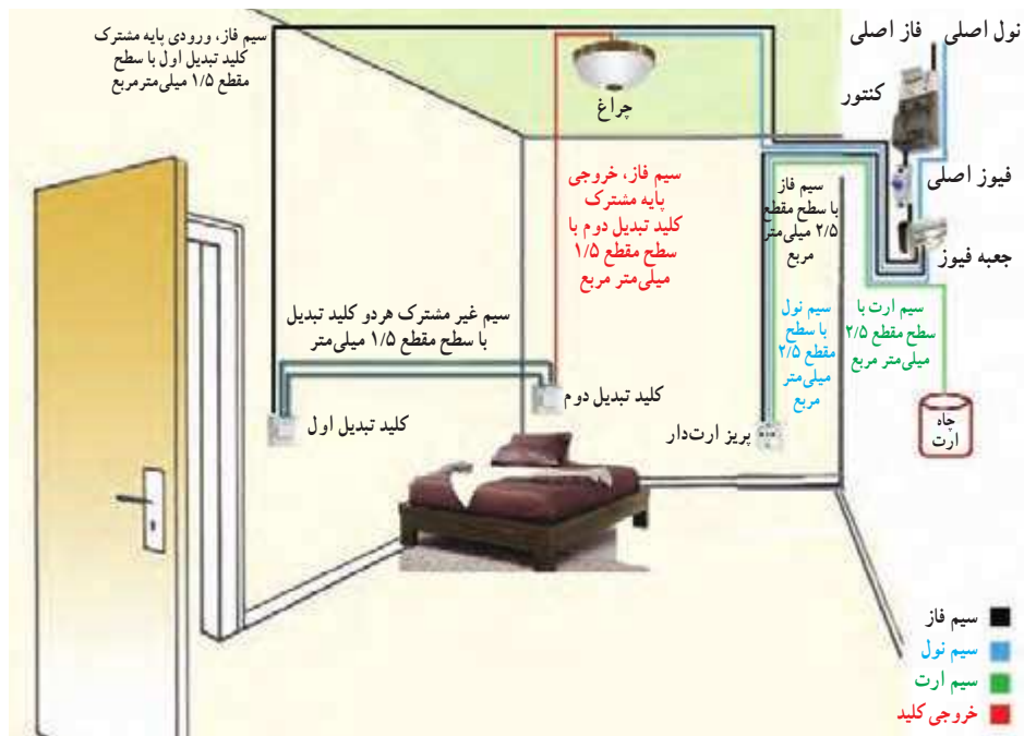
شکل ۱۸-۶ - سیم‌کشی مدار کلید تبدیل
