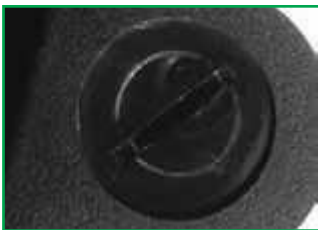
ح - رنگ سبز چشمی، نشانهٔ شارژ بودن باتری است.
