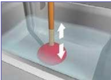
ب – حرکت عمودی لوله بازکن
