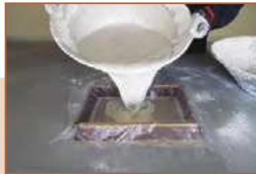
ث - ریختن ملات گچ در قالب
