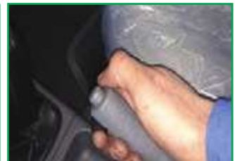
الف - خودرو را خاموش کنید و ترمز دستی را بکشید.
