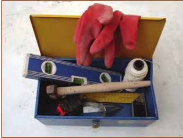
شکل ۸-۱۰- برخی از ابزار مورد نیاز دیوار چینی
