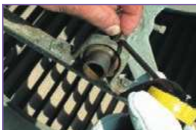
ث- روغن‌کاری یاتاقان‌ها
