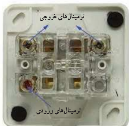
شکل ۱۴-۶- مدار داخلی کلید دو پل
