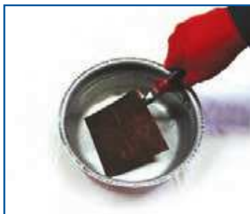
شکل ۹-۱۱- سرد کردن پلاک مسی با آب
