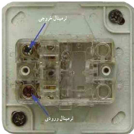
شکل ۴-۶- نمای داخلی یک نمونه کلید یک پل
