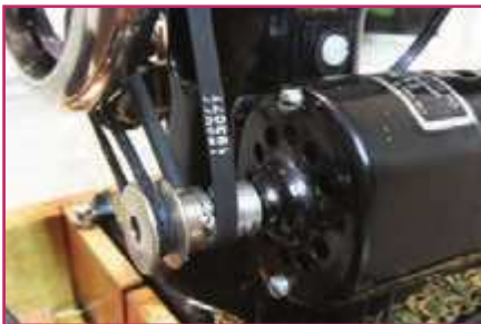
الف- ساز و کار حرکتی تسمه و چرخ تسمه در چرخ خیاطی
