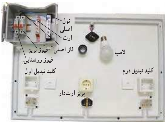
شکل ۲۰-۶- جانمایی قطعات مدار کلید تبدیل
