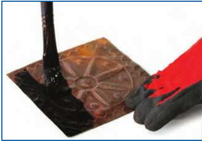
شکل ۱۰-۱۱- آغشته کردن سطح پلاک مسی به قیر
