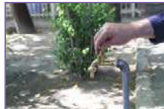
خ - آزمایش آب بندی شیر
